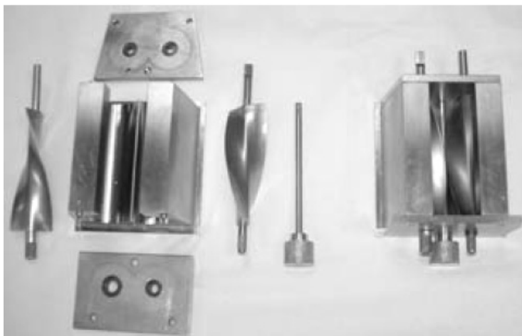
1. ábra: A Mixolab készülék keverő karjai és dagasztó csészéje (Chopin, 2006)
